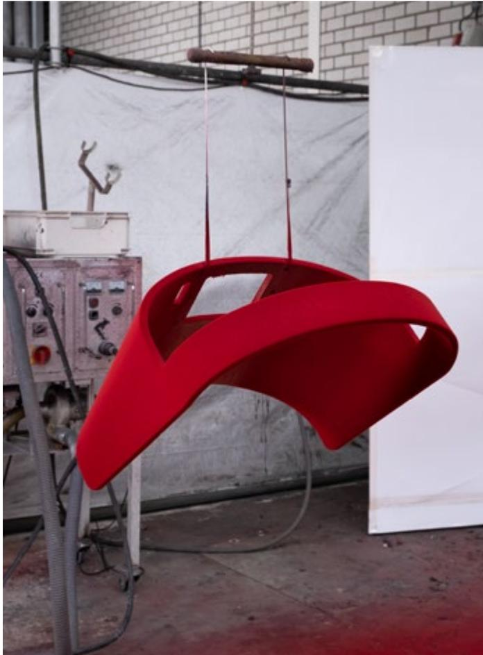
Auftragen der Beflockung bei Flock Technik in Geldrop
