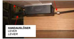
Die Tische werden vor Auslieferung genau eingestellt. Es gibt aber die Möglichkeit bei den Bowdenzug mit einem 8 mm Schlüssel nach zu justieren.
