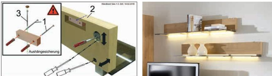
**ACHTUNG:** Bei Montage muss die Verschraubung und Verankerung geprüft werden!
