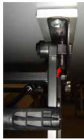
Bei der Verstellung der Tischplatte nach oben mit dem Uhrzeiger drehen.
