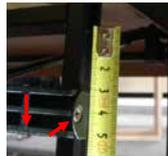
Wenn sich die Tischplatte zu leicht schließt hat man die Möglichkeit mit einem Kreuzschraubenzieher die zwei Klemmbügel links und rechts ca. 1cm nach unten auf 4cm zu setzen.
