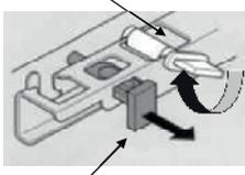
Schieber zum Entriegeln für Ladentnahme
