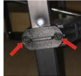
Wenn sich die Tischplatte zu leicht schließt hat man die Möglichkeit mit einem Kreuzschraubenzieher die zwei Klemmbügel links und rechts ca. 1cm nach unten zu setzen.
