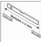
2. Wandleiste waagrecht auf gewünschte Position an Wand befestigen. Die Position der Schrauben mit Mauerdübel müssen jeweils im Bereich der Einhängebeschläge liegen, damit sich die Wandleiste bei Belastung des Hängeelementes nicht verbiegt.
